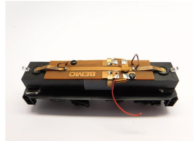
Leiterplatte platzieren Mount the PCB Plaats de printplaat
