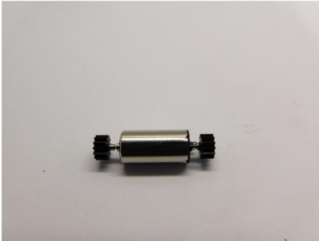
Platzieren Sie die Ritzel Mount the gears Plaats de tandwielen
