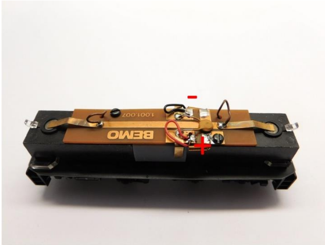
Drähte löten Solder the wires Soldeer de draden
