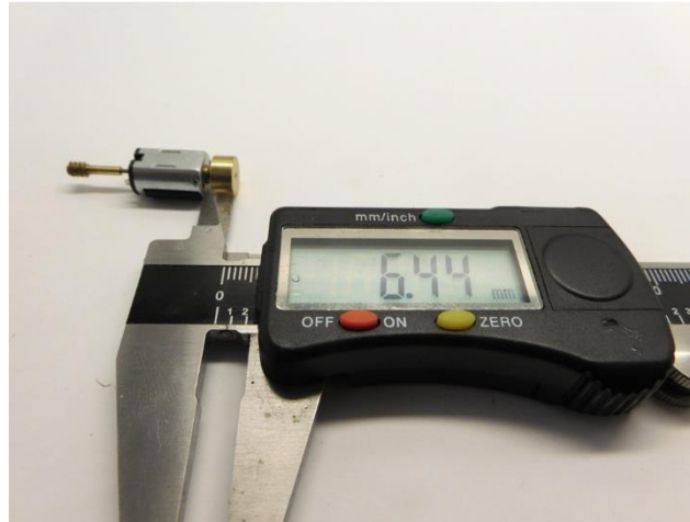
Maße prüfen Check dimensions Controleer de maatvoering
