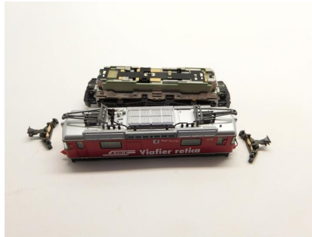
Gehäuse entfernen Remove housing Verwijder de kap
