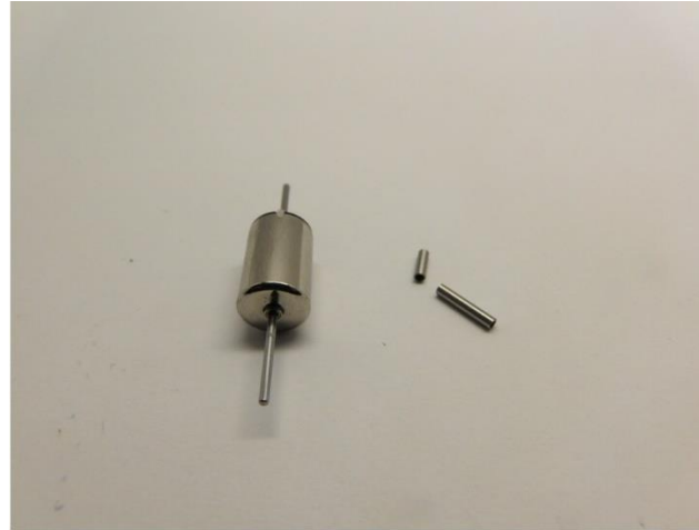
Metalteile werden mit Loctite oder Metal Kleber verklebt Metal parts are glued with Loctite or metal glue Metalen onderdelen worden gelijmd met metaallijm of epoxylijm voor metalen
