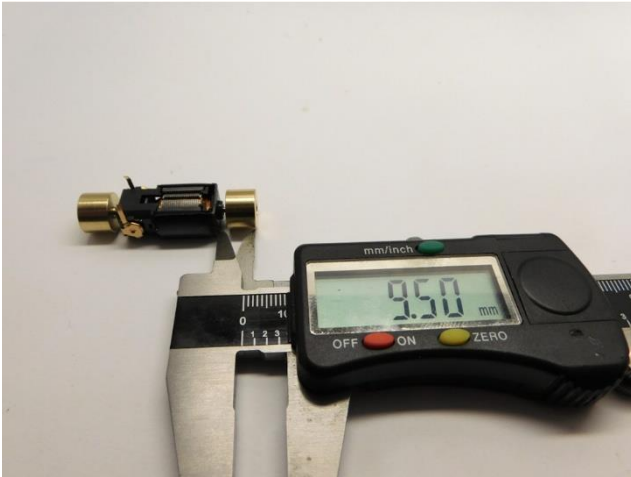
Maße prüfen Check dimensions Controleer de maatvoering
