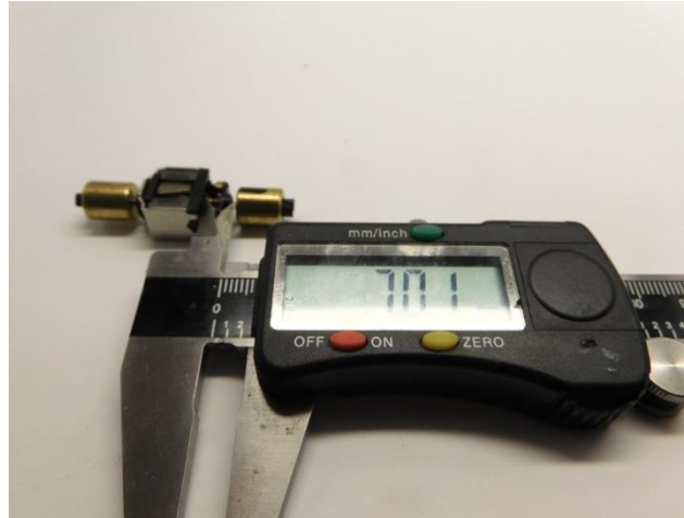
Maße prüfen Check dimensions Controleer de maatvoering
