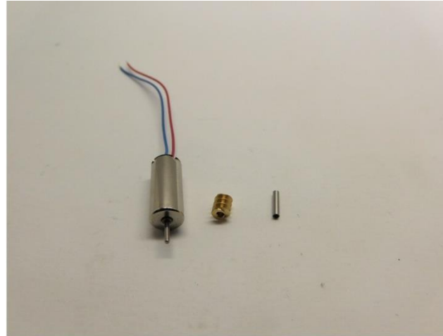
Metallteile werden mit Loctite oder Metal Kleber verklebt Metal parts are glued with Loctite or metal glue Metalen onderdelen worden gelijmd met metaallijm of epoxylijm voor metalen
