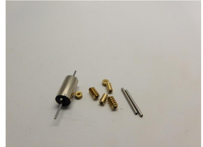
Metall Teile werden mit Loctite oder Metal Epoxy Kleber verklebt Metal parts are glued with Loctite or metal epoxy glue Metalen onderdelen worden gelijmd met metaallijm of epoxylim voor metalen
