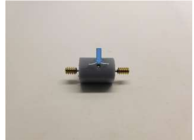
Der Motor wird mit Sekundenkleber in den Motorhalterteile eingeklebt The motor is glued into the motor holder parts with super glue De motor wordt verlijmd met secondelijm of epoxy lijm
