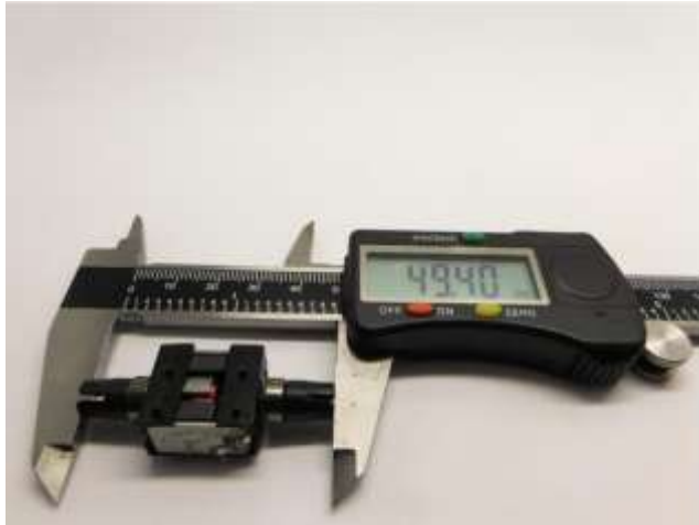
Maße prüfen Check dimensions Controleer de maatvoering
