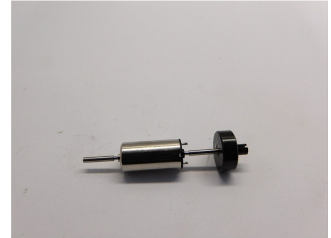
Die erste Metall Teile sind verklebt The first metal parts are glued De eerste metaaldelen zijn verlijmd
