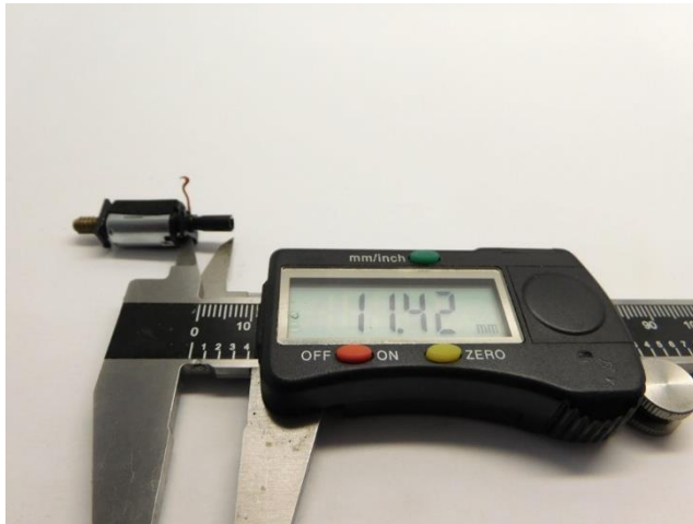
Maße prüfen Check dimensions Controleer de maatvoering
