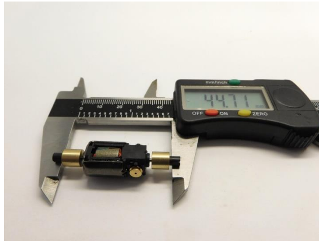
Maße prüfen Check dimensions Controleer de maatvoering
