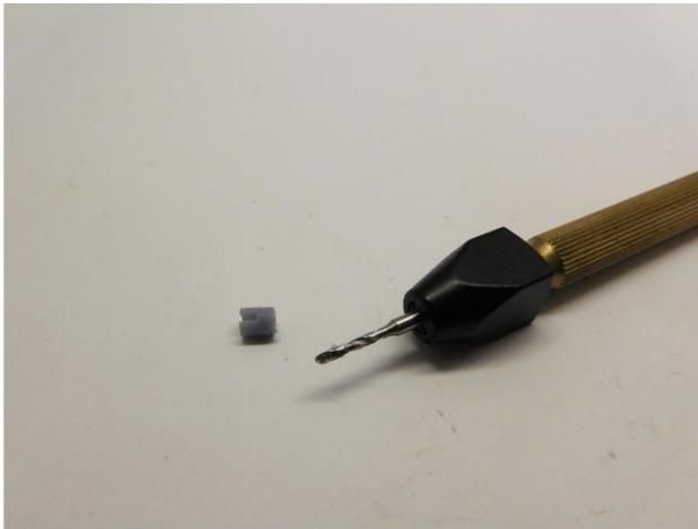
Loch auf 1.5 mm vergrößern Enlarge hole to 1.5 mm Vergroot het gat naar 1.5 mm
