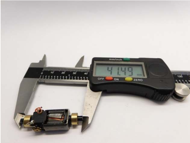
Maße prüfen Check dimensions Controleer de maatvoering
