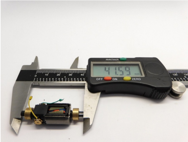
Maße prüfen Check dimensions Controleer de maatvoering
