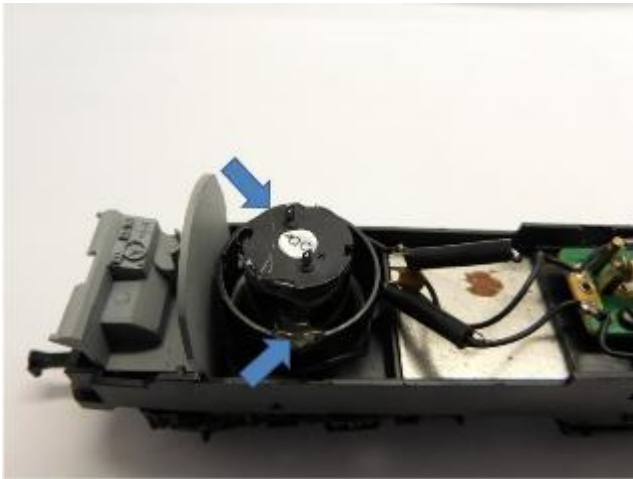
Der Motor wird mit Heizkleber geklebt The motor is glued with hotmelt Verlijm de motor met smeltlijm
