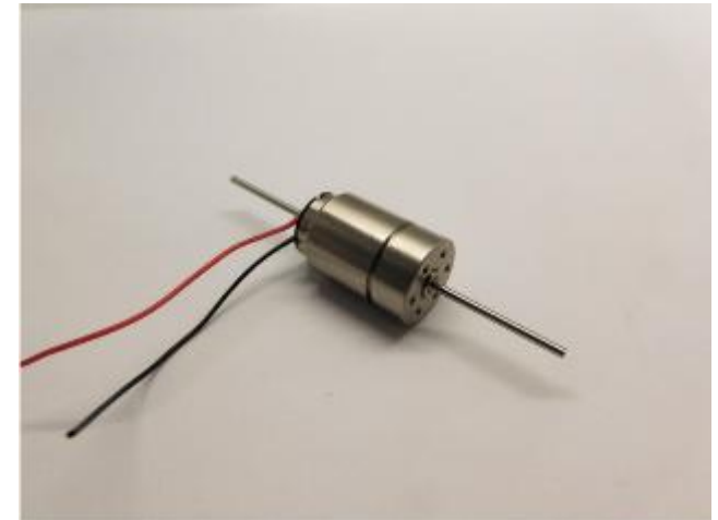
Die Drähte sind verlötet The wires are soldered De draden zijn gesoldeerd
