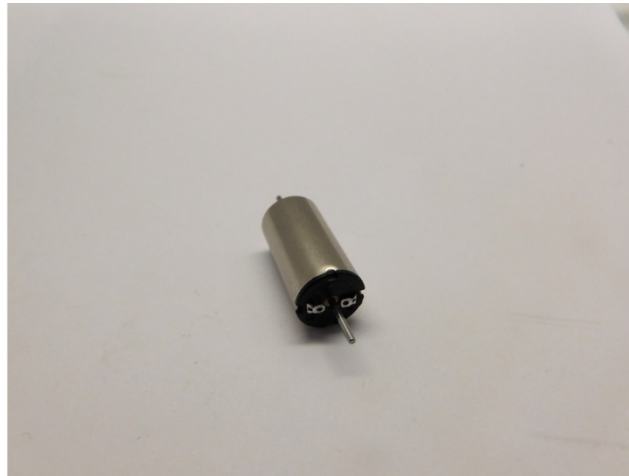
Biegen Sie die Motorkontakte Bend the motor contacts Buig de contacten van de motor
