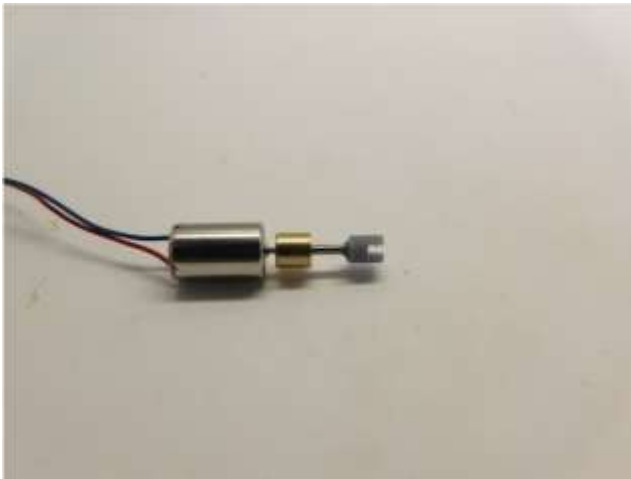
Kleben Sie die Kardankupplung Glue the cardan coupling Verlijm de kardan koppeling
