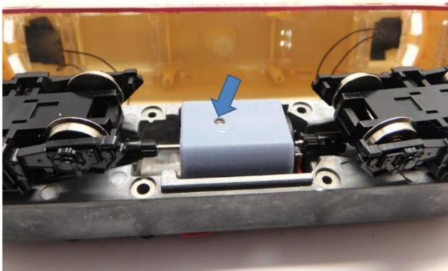
Der Motor wird mit Epoxidkleber oder Sekundenkleber in den Motorhalter eingeklebt The motor is glued into the motor holder with epoxy glue or super glue De motor wordt verlijmd met secondelijm of epoxy lijm
