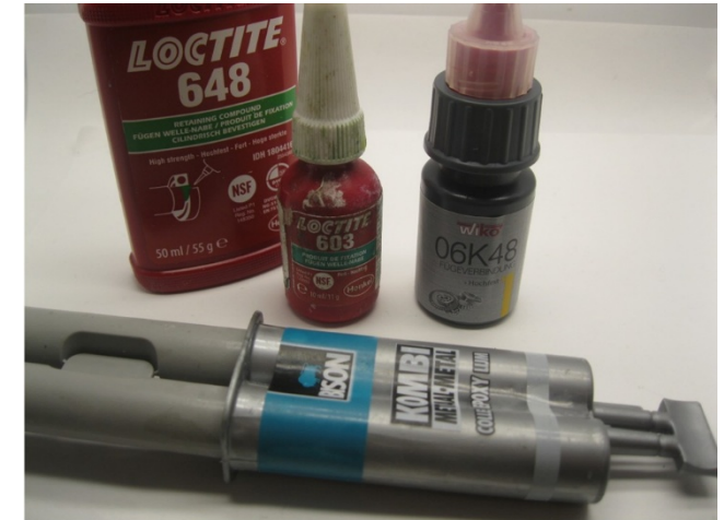
Metal parts are glued with Loctite or metal epoxy glue Metalen onderdelen worden gelijmd met metaallijm of epoxylijm voor metalen
