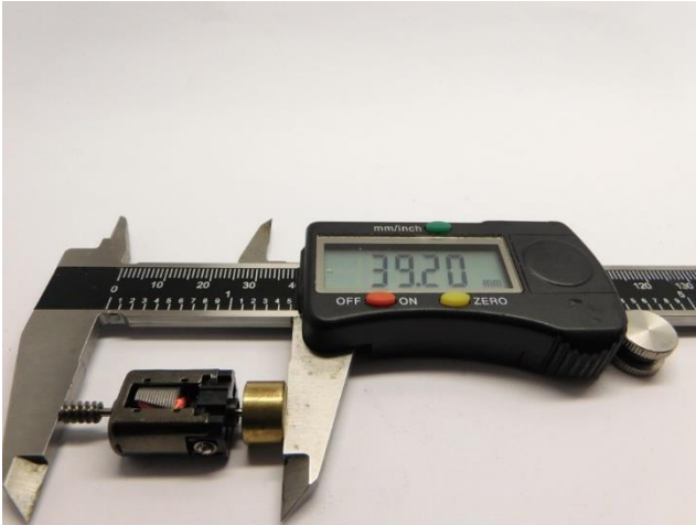
Maße prüfen Check dimensions Controleer de maatvoering
