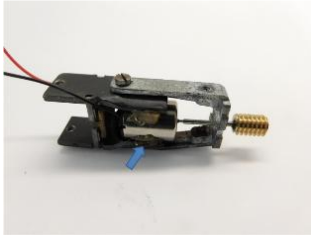
Motor kleben mit Heißkleber Glue the motor with hotmelt Lijm de motor met smeltlijm
