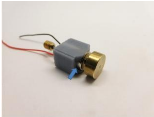
Der Motor wird mit Epoxidkleber oder Sekundenkleber in den Motorhalter eingeklebt The motor is glued into the motor holder with epoxy glue or super glue De motor wordt verlijmd met secondelijm of epoxy lijm
