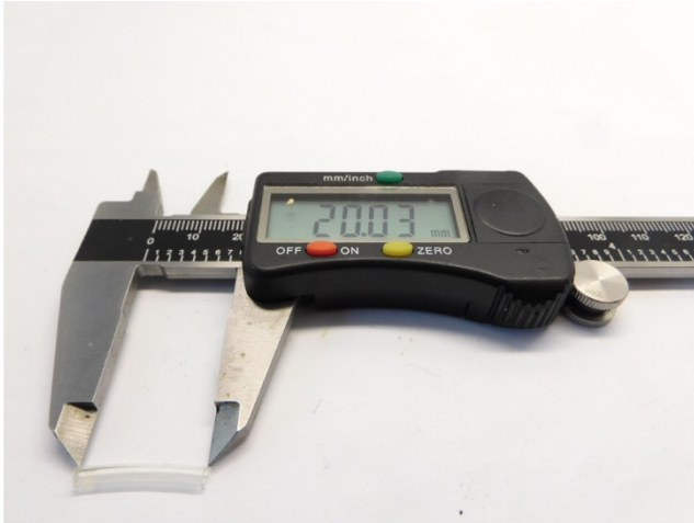
Schneiden Sie ein 20 mm langes Stück der Schlauchkupplung ab Cut a 20 mm section of the hose coupling Snij een stuk van 20 mm van de slangkoppeling
