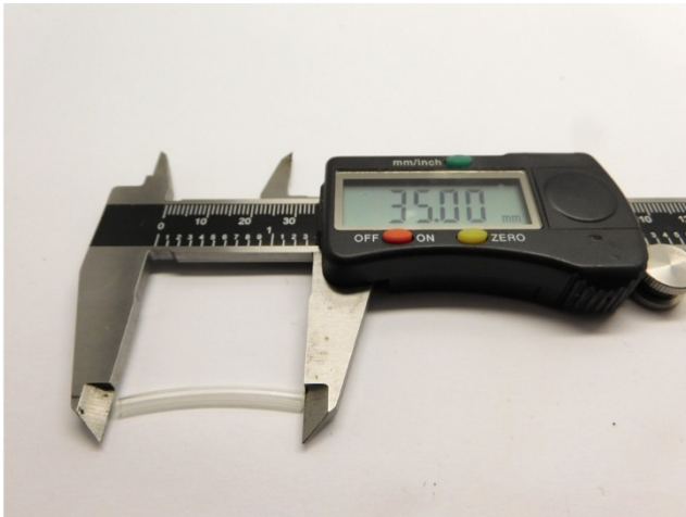
Schneiden Sie ein 35 mm langes Stück der Schlauchkupplung ab Cut a 35mm section of the hose coupling Snij een stuk van 35 mm slangkoppeling
