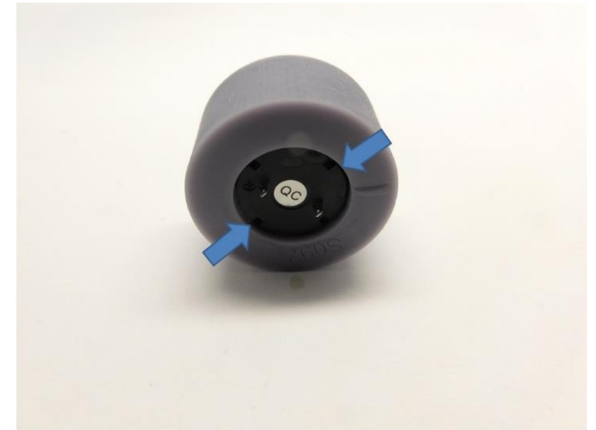
Der Motor wird mit Epoxidkleber oder Sekundenkleber in den Motorhalter eingeklebt The motor is glued into the motor holder with epoxy glue or super glue De motor wordt verlijmd met secondelijm of epoxy lijm
