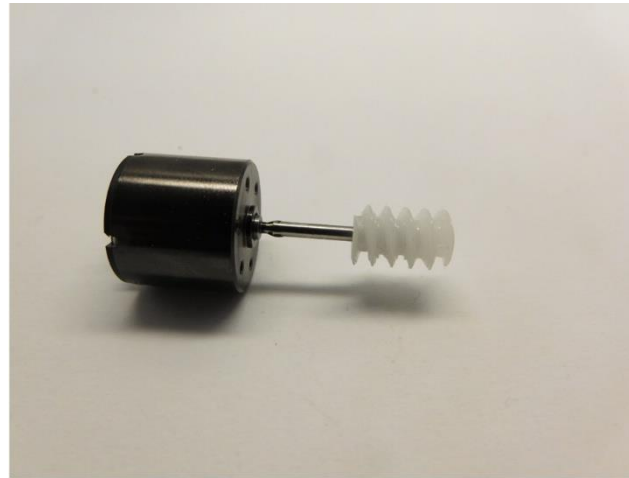
Schnecke kleben Glue the worm gear Lijm het wormwiel
