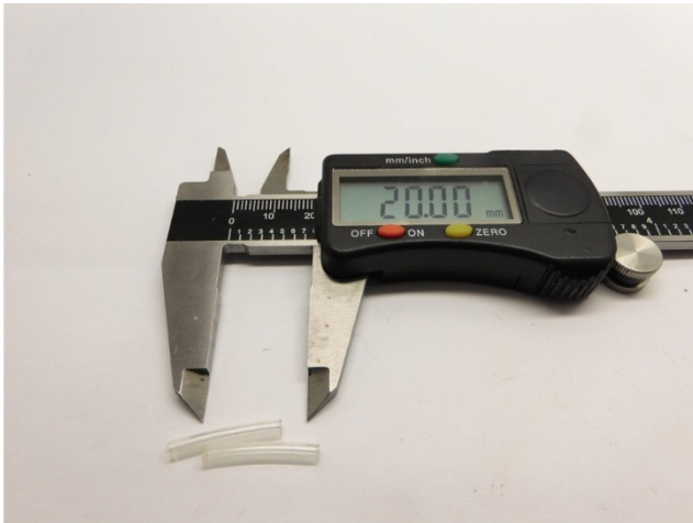
Fertigen Sie 2 Schlauchkupplungen Make 2 pieces of hose coupling Vervaardig 2 stukken slangkoppeling
