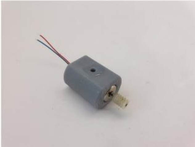
Die Schnecke kleben Glue the worm gear Lijm het wormwiel
