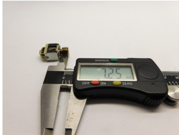
Maße prüfen Check dimensions Controleer de maatvoering
