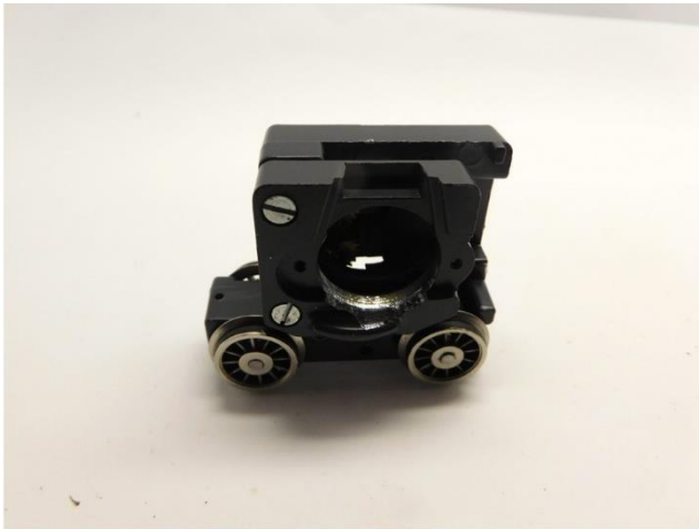
Motorhalter platzieren Mount motor holder Motorhouder plaatsen
