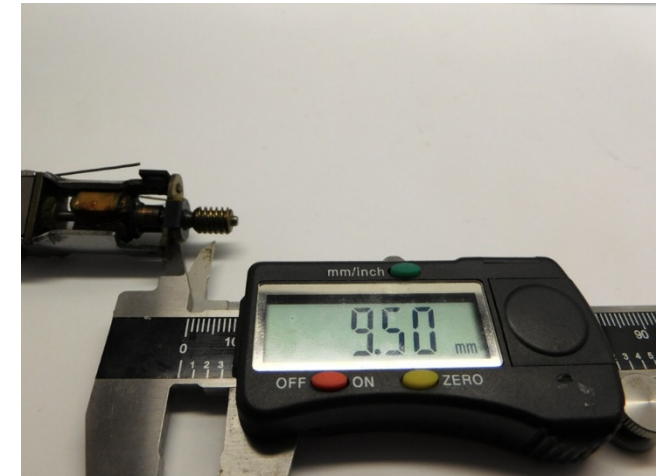
Maße prüfen Check dimensions Controleer de maatvoering
