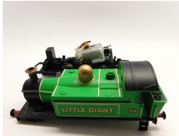
Gehäuse entfernen Remove housing Verwijder de kap
